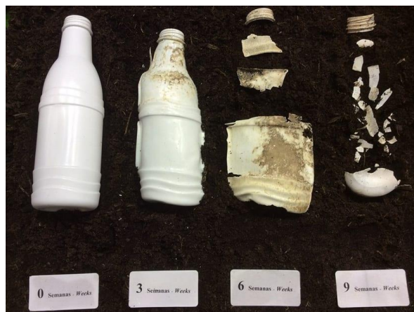
Figura 4: ensayo de biodegradación de un envase (ErcrosBio® LL650 blanco) por compostaje industrial basado en la norma EN 13432.
