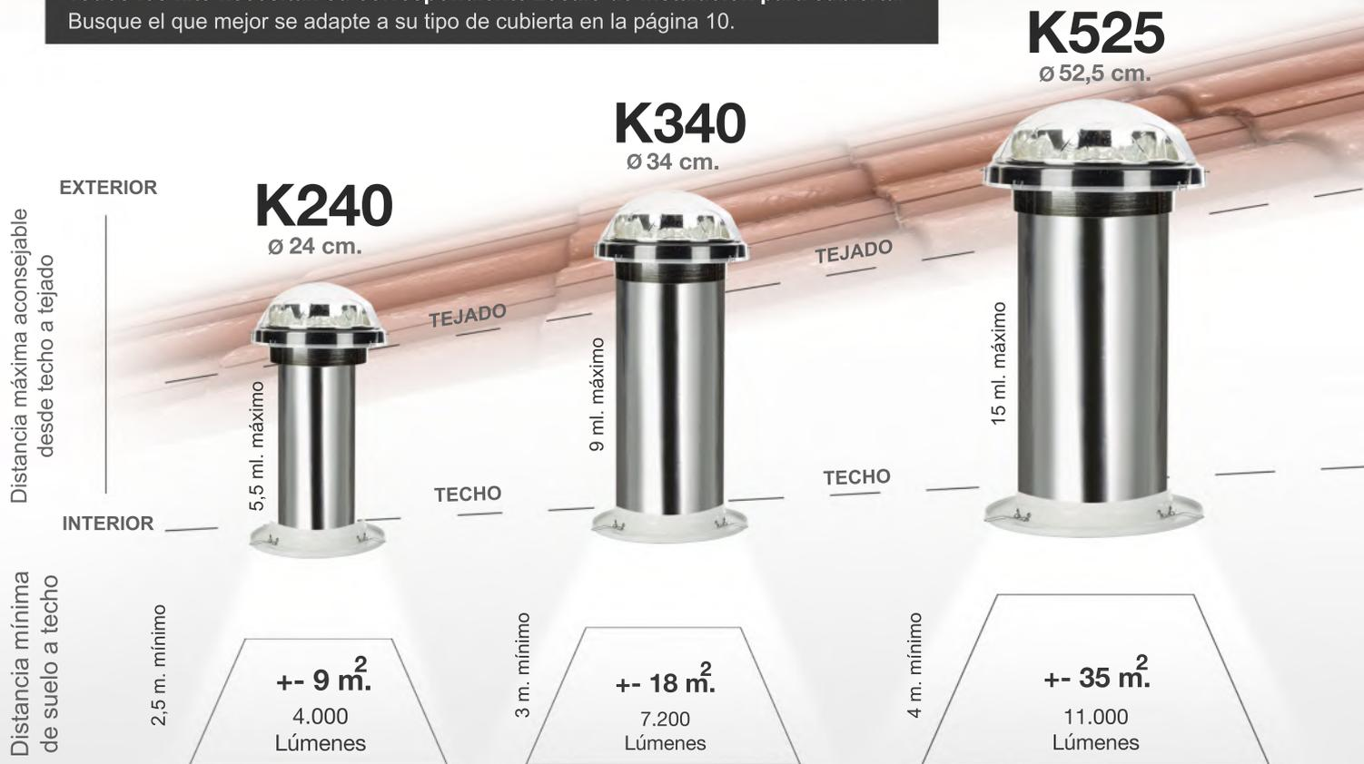
Cobertura de iluminación y capacidad lumínica aproximada. Este dato puede variar en función de la distancia que exista entre el tejado y el interior de estancia y de la cantidad de luz solar.
